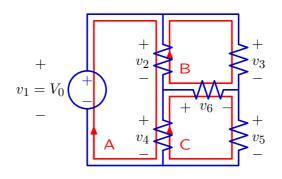
$$\mathsf{A}: -v_1 + v_2 + v_4 = 0$$
