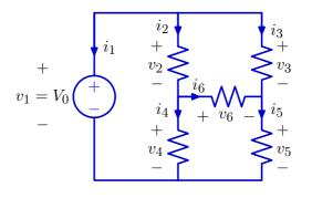
12 unknowns:  $v_1$ ,  $v_2$ ,  $v_3$ ,  $v_4$ ,  $v_5$ ,  $v_6$ ,  $i_1$ ,  $i_2$ ,  $i_3$ ,  $i_4$ ,  $i_5$  and  $i_6$ .
