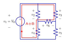
$$A: -v_1 + v_2 + v_4 = 0$$
