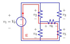
$$\mathsf{E}: -v_1 + v_2 + v_6 + v_5 = 0$$
