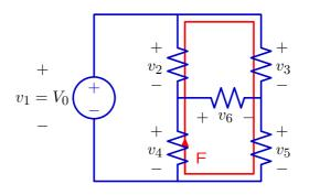
$$\mathsf{F}: -v_4 - v_2 + v_3 + v_5 = 0$$
