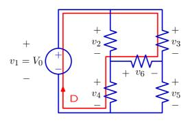
$$\mathsf{D}: -v_1 + v_3 - v_6 + v_4 = 0$$
