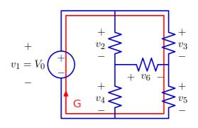
$$\mathsf{G}: -v_1 + v_3 + v_5 = 0$$
